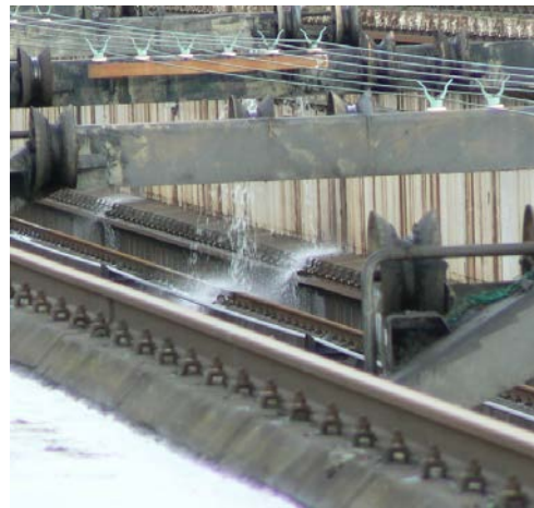
Dispositifs de récoltes des eaux et égouttage encrassés et/ou cassés.
